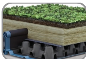
Cubiertas vegetales. Medio edáfico estructural, vegetación y drenaje.
